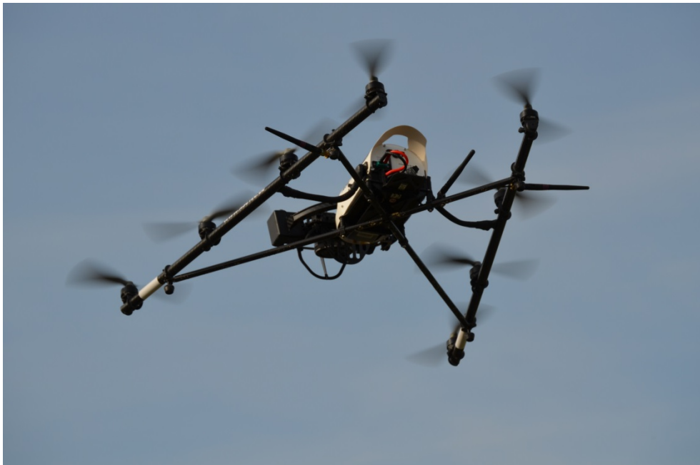
Abbildung 2-3: UAS - Drohne mit Spiegelreflexkamera (Foto: Hannes Sahl)
