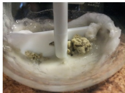
Bild 3.21: „High-C“ - Hochkonzentrations – Eintopfsynthese von [MMT/PEI_{10Q}^{80R10}] im Labormaßstab
