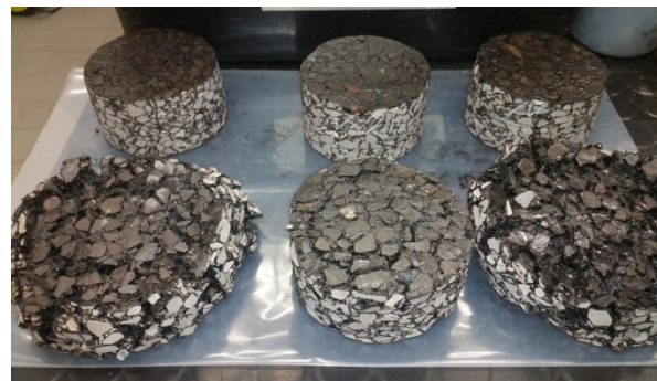
Bild 7.7 Endzustand der Probekörper nach Durchführung der Druckschwellversuche (oben: nanomodifizierter Asphalt; unten: Referenzasphalt)
