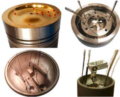
Abb. 3: Sukzessive Bestückung eines Messkolbens zusammen mit der Fertigung des dazu angepassten Schwingensystems. Oben links ist die bedampfte Goldschicht dargestellt, wobei die nicht mehr sichtbaren Messstellen der Oberflächenthermoelemente als rote Punkte visualisiert werden. Oben rechts ist die Unterseite der Kolbenoberteils und unten links die Unterseite des Kolbenunterteils dargestellt, jeweils mit den ersten Thermoelementen und deren Verlegung im Material. Unten rechts sind die gefertigten und zusammengesetzten Schwingenelemente als Führung von Kolben zum Pleuel dargestellt.
