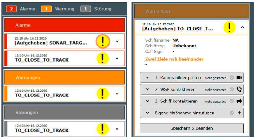
Abb. 10: Bildausschnitt Alarmfenster und Detailsicht mit Maßnahmen
