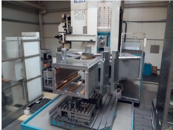
Abb. 14: Einpassen der Gleitleisten am Walzsupport bei Dreiling Maschinenbau GmbH
