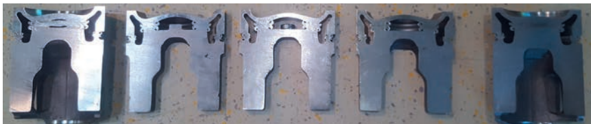
Abb.13: visionärer Leichtbaukolben mit einem Durchmesser 160 mm
