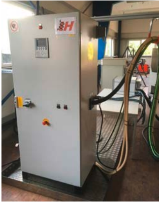
Abb. 2: HF-Leistungsumrichter 70kW/700 kHz
