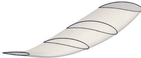
Abb. 2: Darstellung des Aufbaus des HiOfoils mit Profilschnitten
