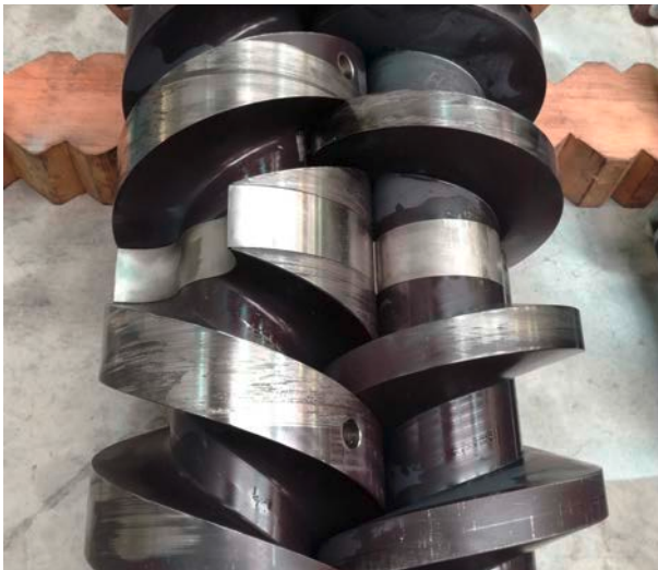
Abb. 4: doppelflutiger Rotorsatz mit LW-profilierten Förderschrauben und rotierendem Steuerschieber
