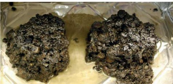
**Bild 31:** MPK AC 16 BS, Quarzit, k = ca. 85 % nach 96 h statischer Wasserlagerung bei 60 °C
