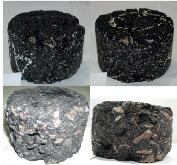
**Bild 25:** Einfluss der Konditionierungsverfahren am Beispiel Quarzit
