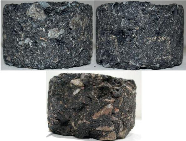
**Bild 26:** Einfluss der Gesteinskörnung am Beispiel 72 h, 60°C Wasserlagerung
