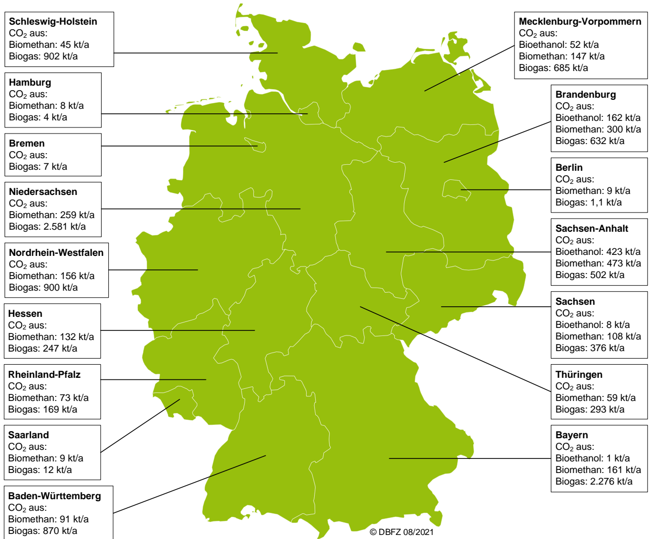
Abbildung 4-19 Biogene CO 2 -Punktquellen in Deutschland aufgeteilt nach Bundesländern, Hinweis: ohne Holzverarbeitung und -nutzung, eigene Berechnung auf Basis von [AEE (2021); bdew (2021); Billig (2019)], Annahmen: CO 2 -Gehalt in Biogas: 45 % v/v; Energiegehalt in Biogas: 6,25 kWh/m 3 (i. N.); Effizienz der Energieerzeugung aus Biogas: 40,16 %
