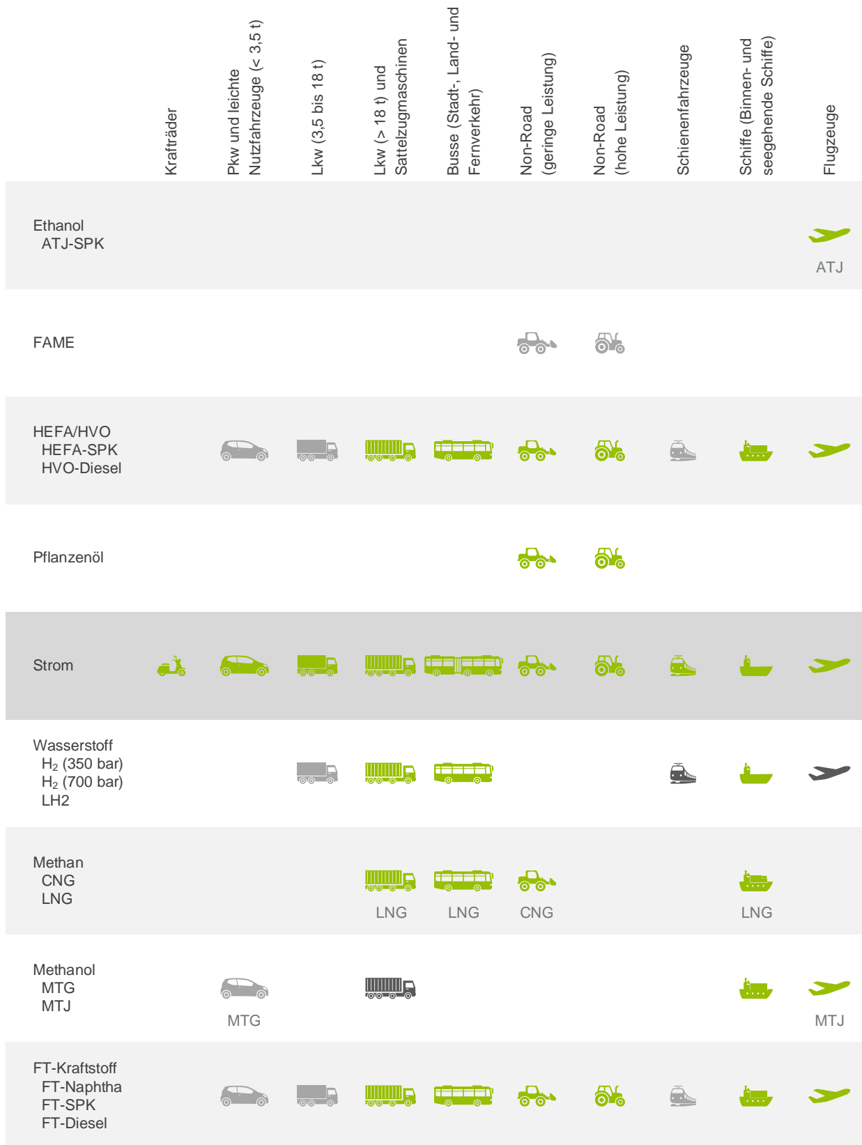
Abbildung 9-3 Fahrzeug-Energieträger-Matrix für Deutschland in 2045 (grün – sehr wahrscheinliche Option, schwarz – eventuell eine Option, hellgrau – Option für Restbestand)
