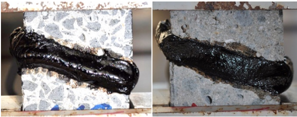
Bild 98: Einbauzustand der Systemprüfkörper bei +60 °C (links: FM1; rechts: FM4)
