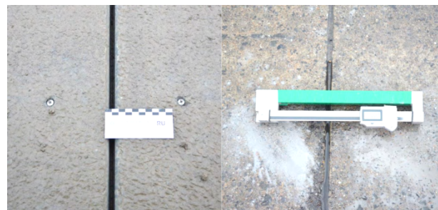
Bild 19: Messmarken und Fugenspaltmessung mit einem Setzdehnungsmesser (System der BAST in Anlehnung an [7])
