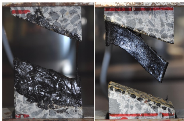
Bild 84: Versagensbilder im statischen Zug-/Scherversuch nach 10%iger Vordehnung und zyklischer Beanspruchung (links: FM1; rechts: FM3)
