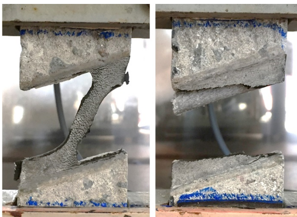
Bild 190: Zustandsbilder im statischen Zug-/Scherversuch der originären Systemprüfkörper FM7 der A23 T1.1 (links) und A23 T1.2 (rechts) Prüftemperatur: -20 °C
