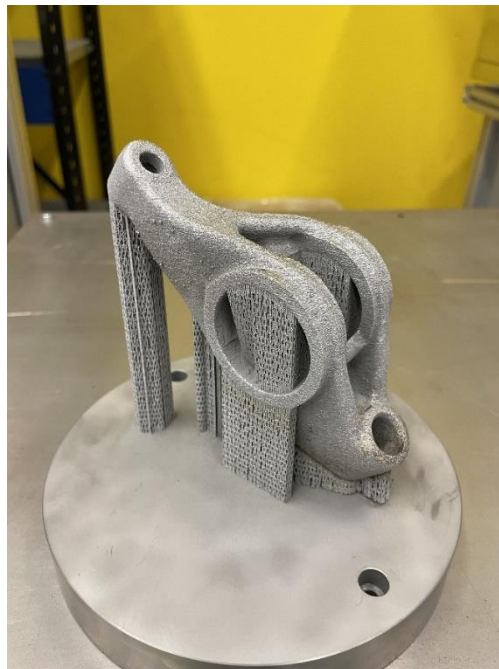
Abbildung 37: Demonstrator gefertigt mit modifizierten "speed"-Parameter
