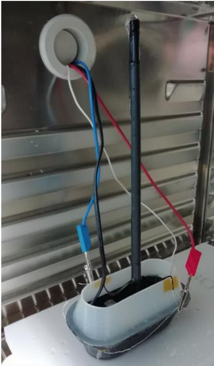
Bild 17: Beheiztes Fluidsystem im Klimaschrank bestehend aus beheiztem Gefäß, beheiztem Rohr und einer Pumpe
