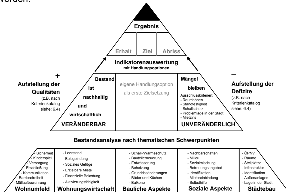
Abbildung 29: Entscheidungsmatrix in Bezug auf Projekte des Bestandsersatzes u.a. mit beispielhafter Nennung thematischer Schwerpunkte bei der Bestandsanalyse
