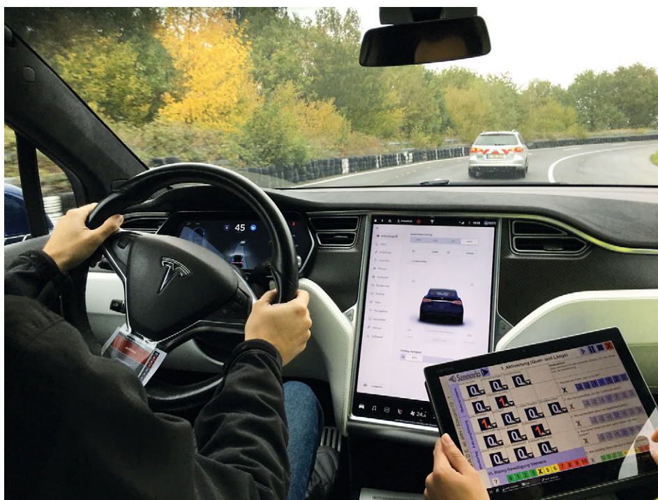
Das Tablet-Tool kann zukünftig dazu genutzt werden, die Sicherheit der Mensch-Maschine-Interaktion von Serienfahrzeugen in Probandenstudien auf Teststrecken zu bewerten
