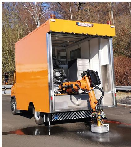
*Roboter im Messfahrzeug*
