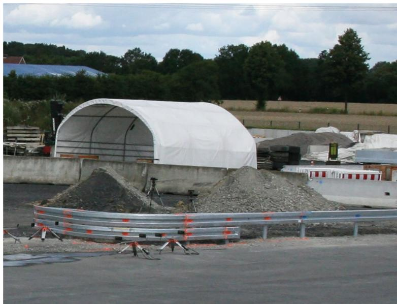
Skizze einer gekrümmten Schutzeinrichtung für Einmündungen (links) und Prototyp auf dem Testfeld (rechts)
