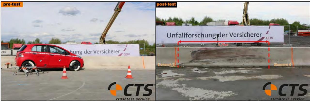
Abbildung 5-20: Prüffahrzeug und Kontaktsuren am Anprallort
