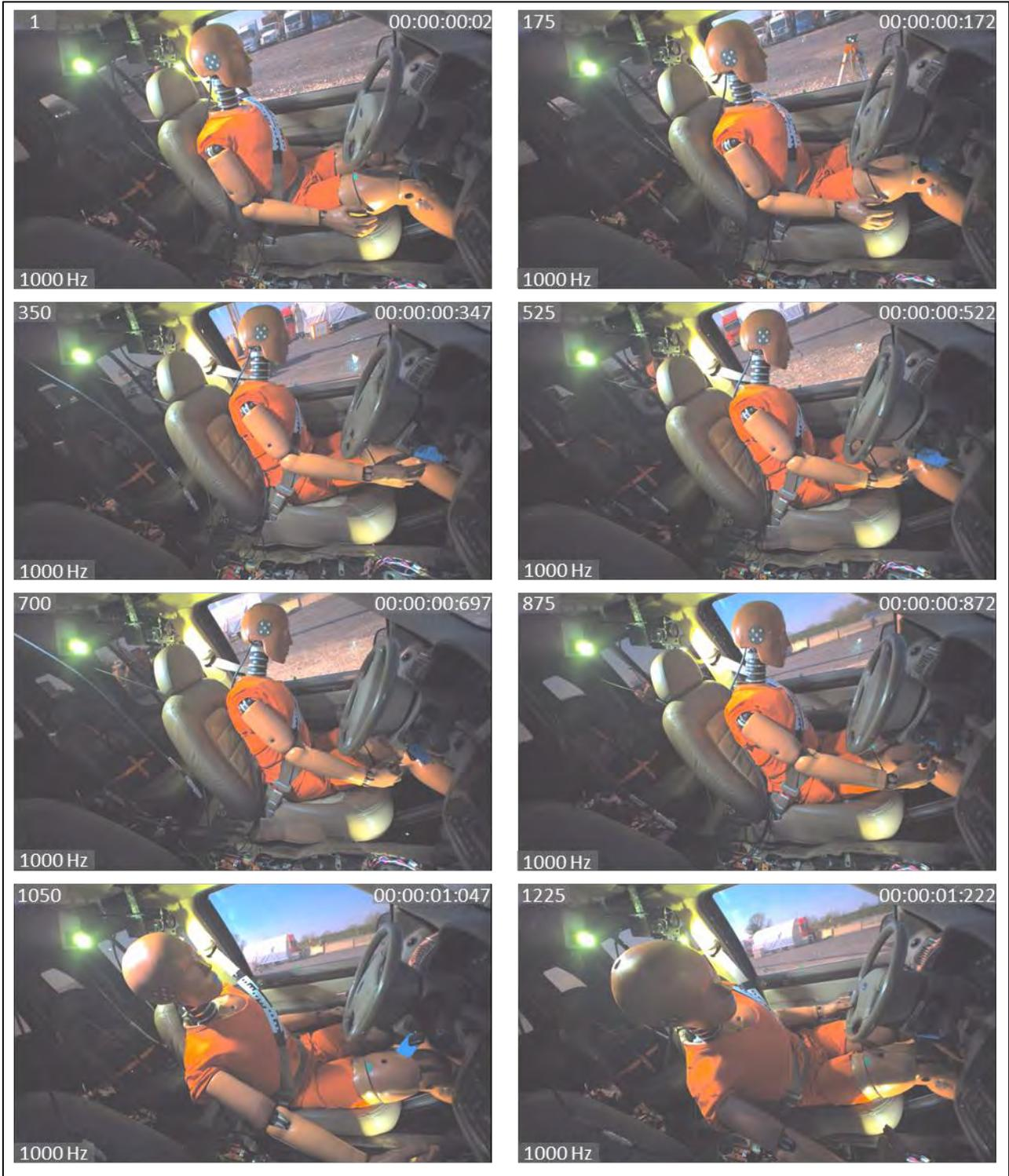
Abbildung 5-19: Anprallversuch 2 – Bildsequenz – OnBoard (0 ms bis 1225 ms)
