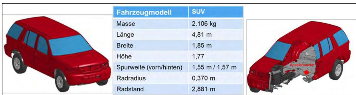
Abbildung 6-2: Numerisches Fahrzeugmodell "Schweres Fahrzeug"
