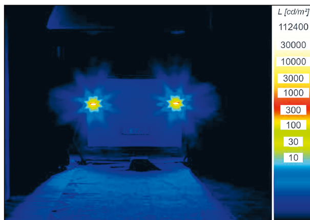
Bild 4-5 Leuchtdichteverteilung für die Nacht-Situation mit eingeschalteter Bremsleuchte
