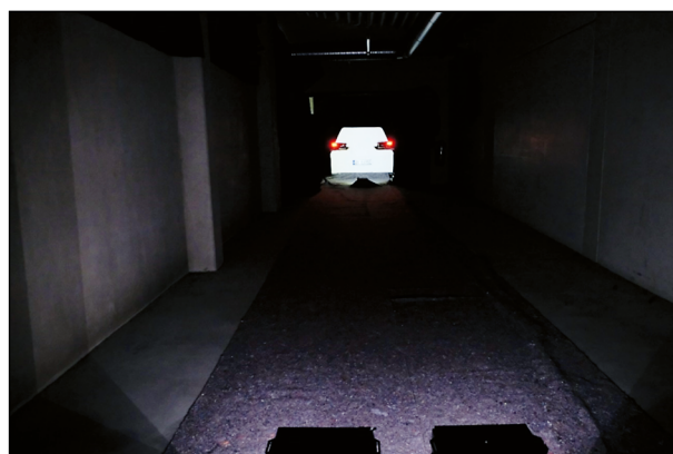
Bild 4-4 Nachgestellte Nacht-Situation aus Probandensicht für die mesopische Bedingung mit eingeschalteter Bremsleuchte
