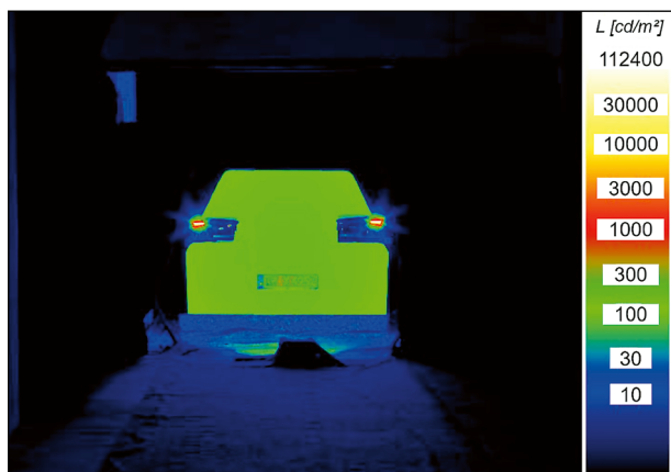
Bild 4-3 Leuchtdichteverteilung für die Tag-Situation mit eingeschalteter Bremsleuchte
