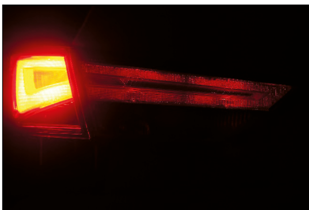
Bild 4-10 Schlussleuchte der Glühlampen-Version ausschließlich im Kotflügelsegment
