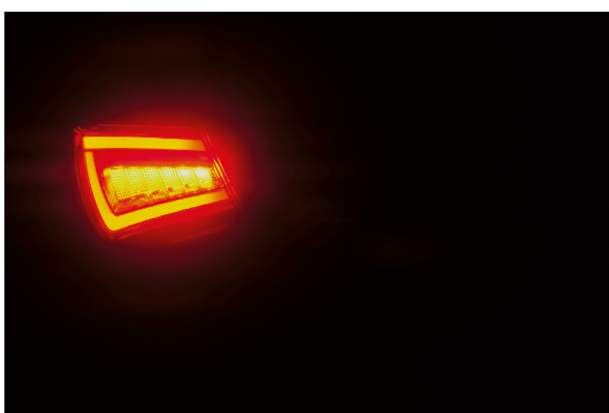
Bild 4-11 Schlussleuchte der LED-Version ausschließlich im Kotflügelsegment
