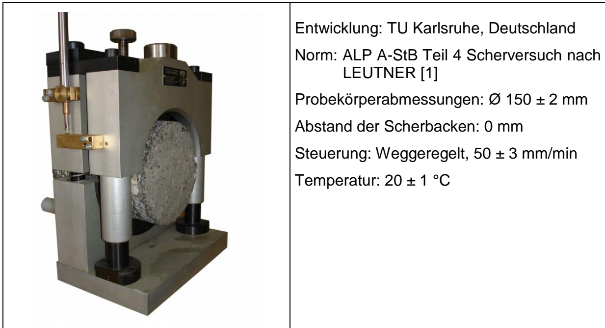
Abbildung 5: Scherversuch nach LEUTNER, Deutschland
