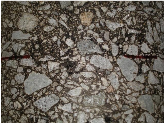
Abbildung 2: Schichtengrenze am Bohrkern (SMA 0/8 S / ABi 0/16 S)
