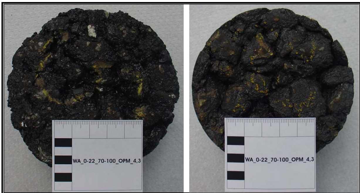
Abbildung 6.9: Beispiel für die Oberfläche eines MPK (links) und eines Bohrkerns (rechts) aus einem WDA 0/22
