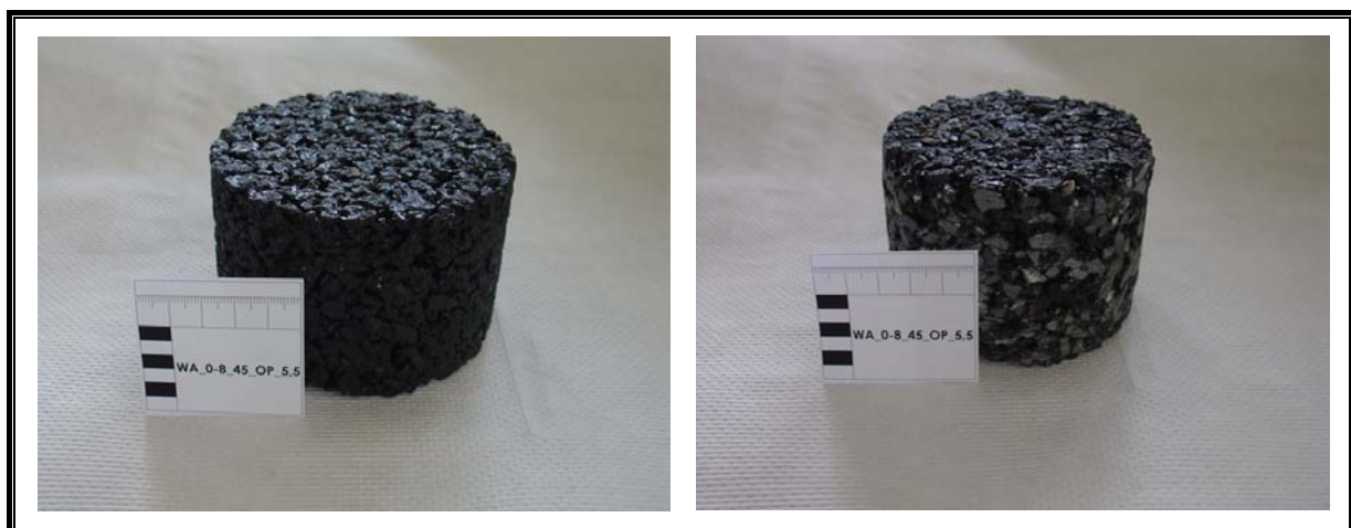
Abbildung 5.1: Beispiel für einen Marshall-Probekörper mit abgebohrter Mantelfläche (rechts – mit einer abgebohrten Mantelfläche)
