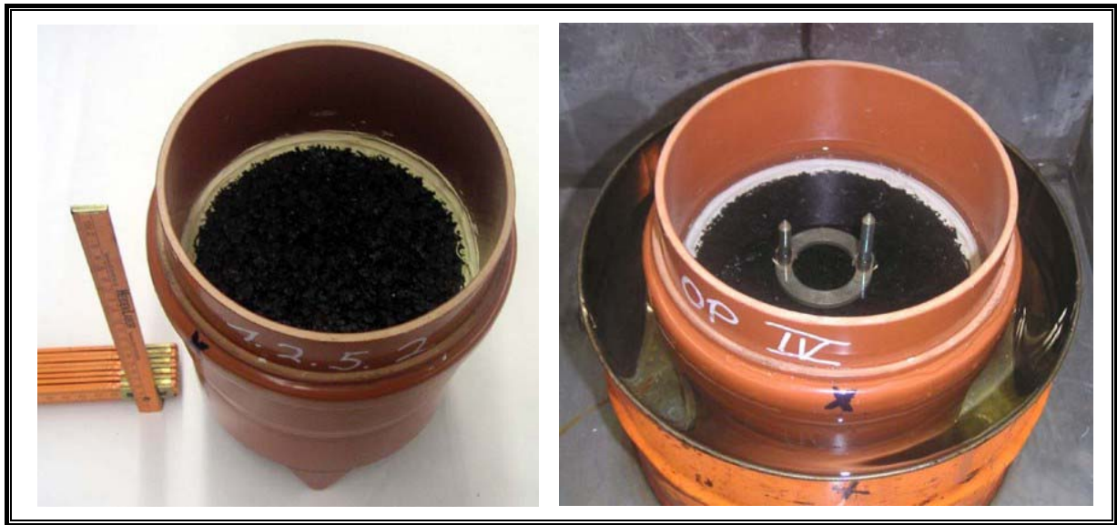
Abbildung 5.4: Verwendete Versuchsausrüstung in Anlehnung an die DIN 18035, Teil 6, links: eingeklebter Probekörper vor der Versuchsdurchführung, rechts: Apparatur im Betriebszustand
