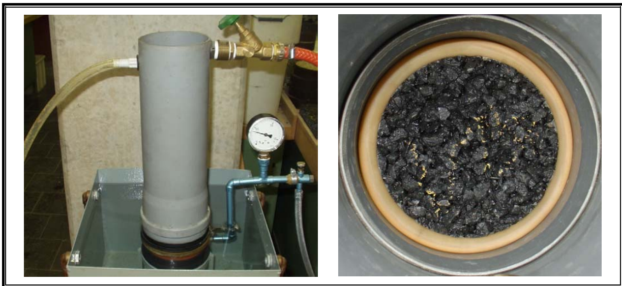
Abbildung 5.2: Versuchsanordnung für die Wasserdurchlässigkeitsprüfung nach DIN EN 12697, Teil 19, rechts: Druckzelle im Betriebszustand, links: eingespannter Probekörper vor der Beanspruchung mit Wassersäule
