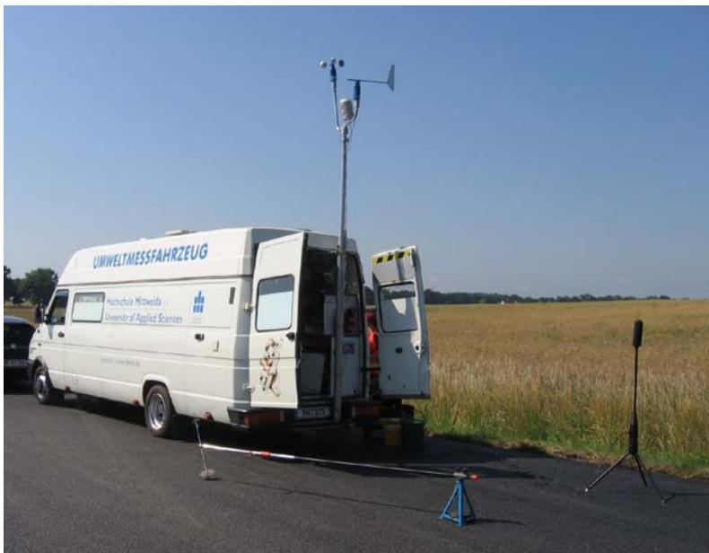
Abbildung 46: Messfahrzeug zur Überwachung der Windgeschwindigkeiten während der in-situ Messungen
