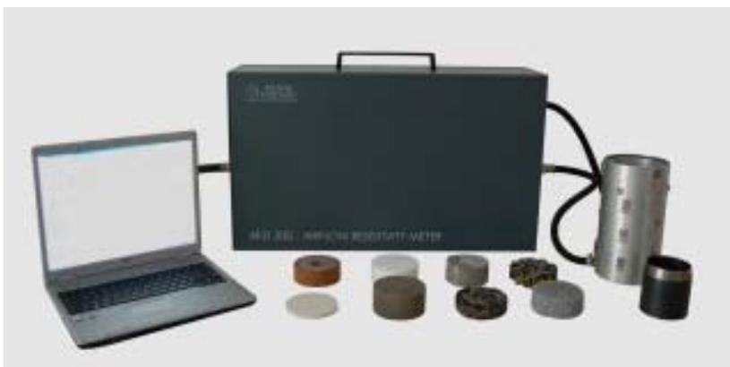
Abbildung 6: Messaufbau zur Bestimmung der Strömungsresistenz
