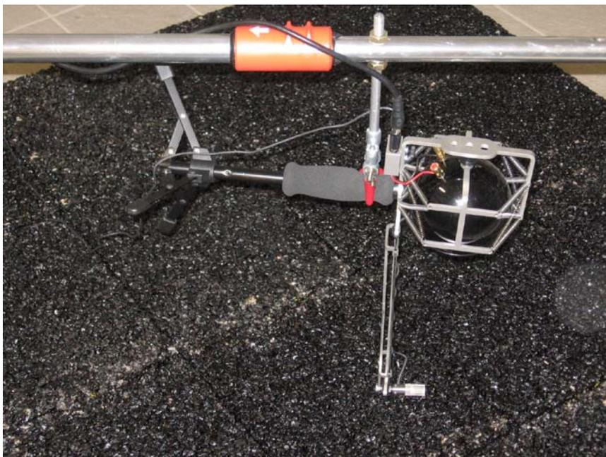
Abb. 6: Befestigung des Sensors mit Hilfe einer Klemme
