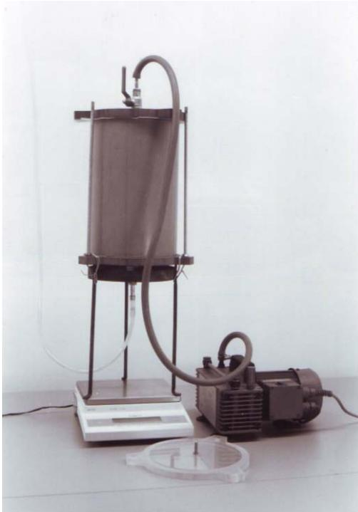
Abbildung 13: Messaufbau zur Bestimmung des zugänglichen Hohlraumgehalts mit Hilfe von Wasser
