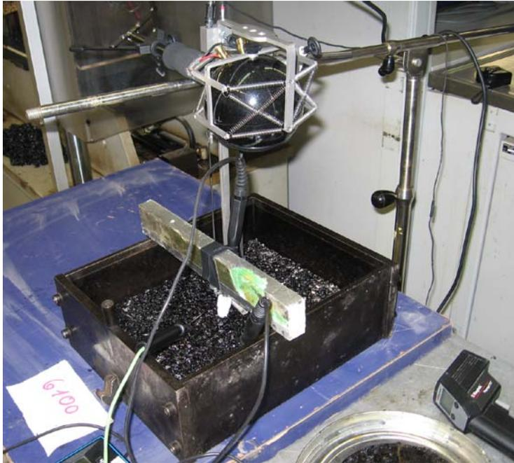
Abbildung 40: akustische Messungen während des Abkühlprozesses einer Asphaltplatte mit für die Herstellung notwendigem Stahlrahmen; Temperaturüberprüfung in Höhe der Sonde, auf der Asphalt-oberfläche, im Asphalt
