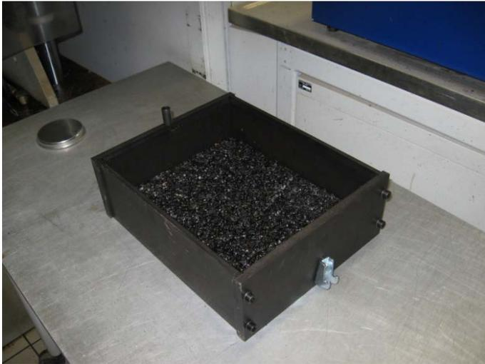
Abbildung 39: Asphaltplatte mit für die Herstellung notwendigem Stahlrahmen
