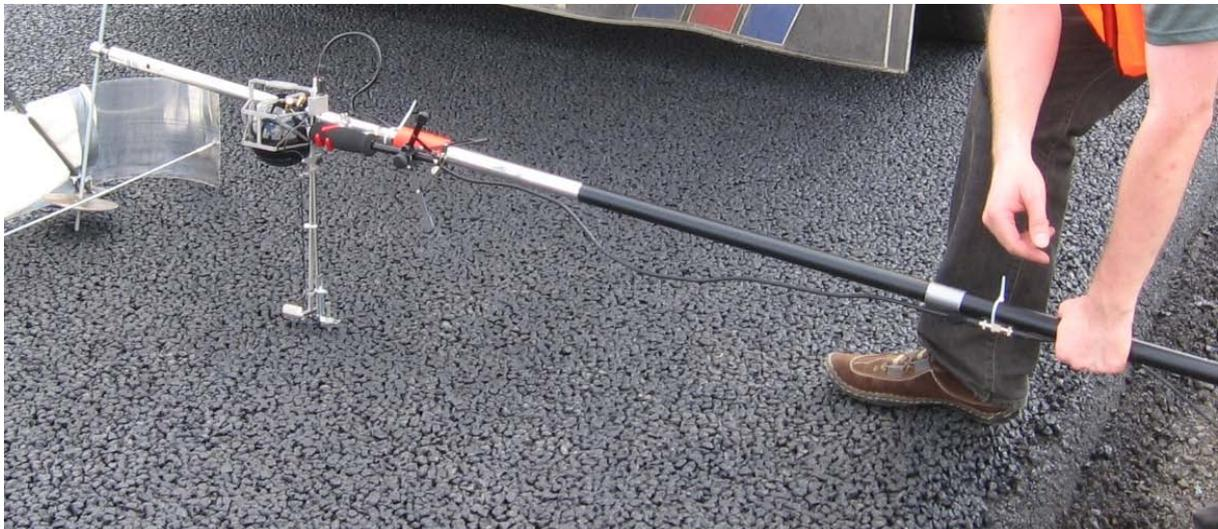
Abb. 1: Messaufbau zur messtechnischen Bestimmung der Oberflächenimpedanz einer Asphalt-schicht mithilfe eines Druck-Schnelle-Sensors
