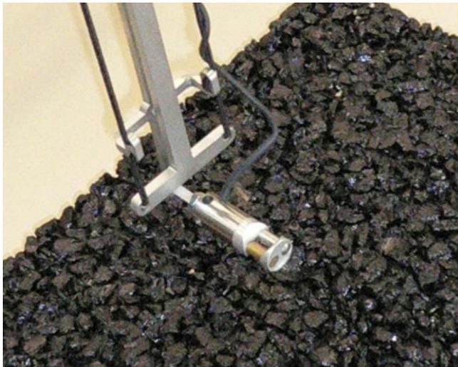
Abb. 4: Ausrichtung des Druck-Schnelle-Sensors entsprechend dessen richtungsabhängiger Empfindlichkeit
