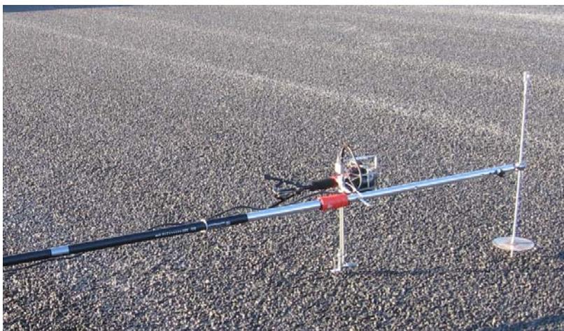
Abb. 3: Teleskopstange als spezielle Halterung des Druck-Schnelle-Sensors
