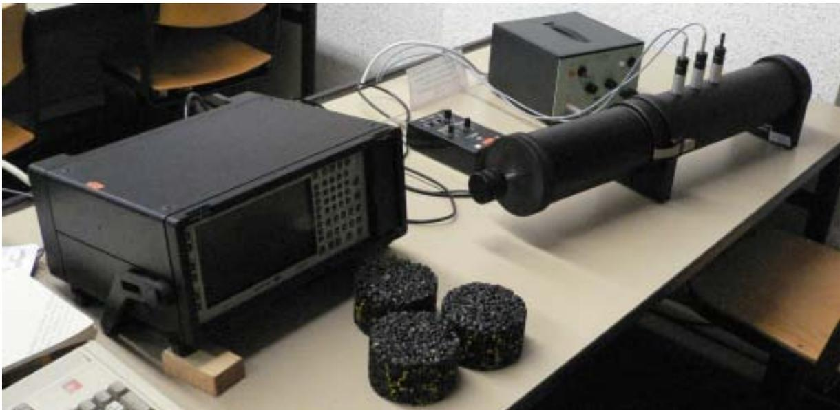
Abbildung 3: Messaufbau zur Bestimmung akustischer Eigenschaften im Impedanzmessrohr
