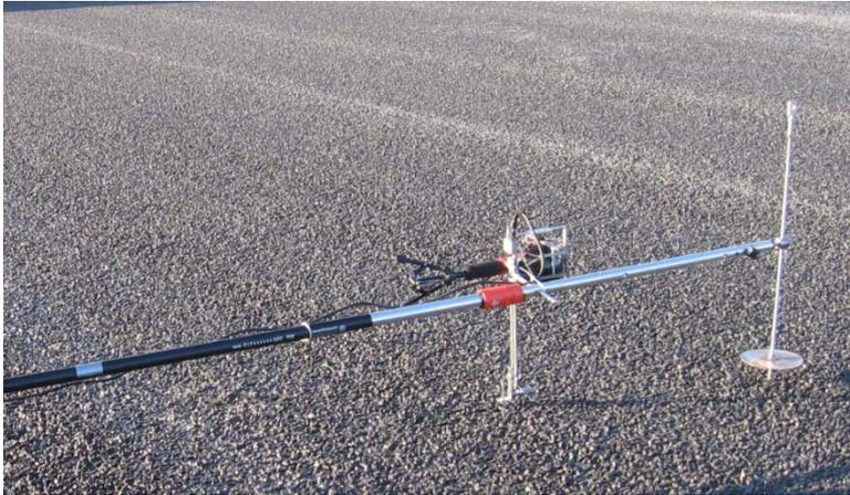
Abbildung 47: Messaufbau zur Bestimmung der Oberflächenimpedanz einer Asphaltsschicht mithilfe des Druck-Schnelle-Sensors
