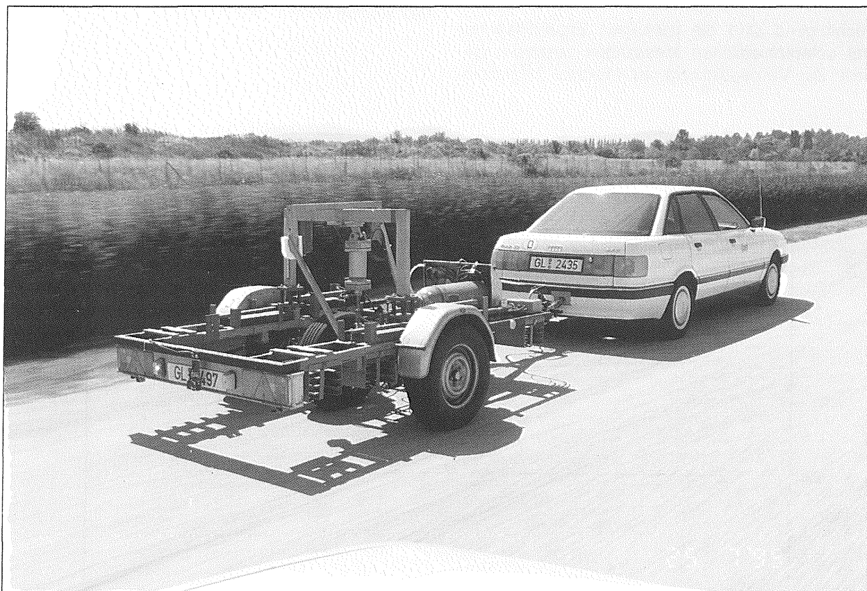
Bild 7.1: Rollwiderstandsmessung auf der Südgeraden des Rundkurses
