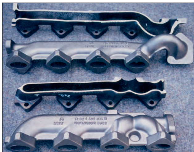
Bild 205: Dünnwandiger Abgaskrümmter für 8-Zylinder-Otto- und Dieselmotoren aus EN-GJSA-XNiSiCr35-5-2 (Bild: Montforts, Mönchengladbach)
