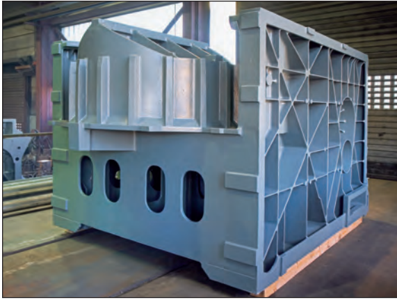
Bild 7: Fräsmaschinengehäuse aus EN-GJS-400-18 mit gegen Schwingungen optimierter hochsteifer Rippenstruktur, Gewicht 12 t (Bild: SHW, Aalen-Wasserafingen)
