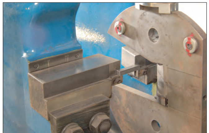
Bild 123: Kontrolle der Zähigkeitseigenschaften von GJS-Gussteilen im Kerbschlagbiegeversuch im Werkstofflabor einer Gießerei (Bild: CLAAS GUSS, Bielefeld)
