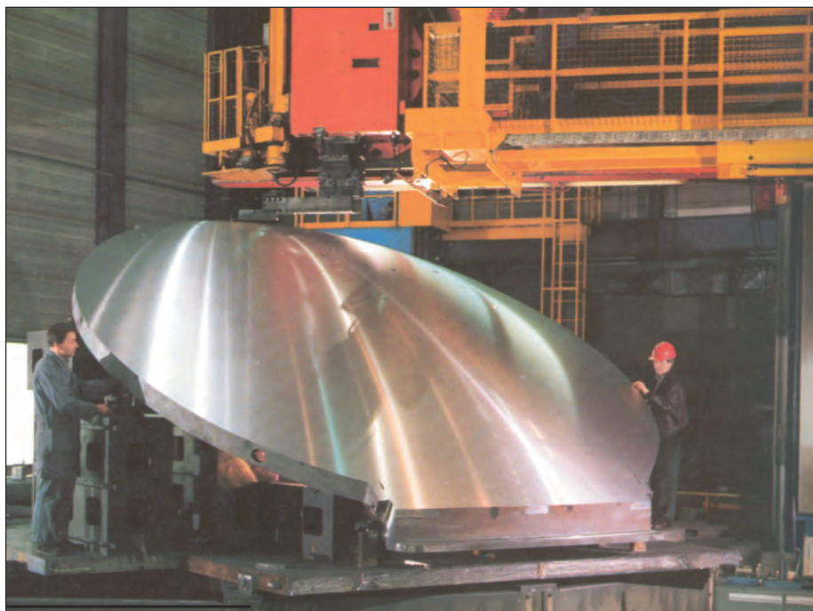
Bild 186: Aus vier Teilen bestehende Laminierform für eine Satellitenantenne aus EN-GJS-400-15, Gesamtgewicht 17,1 t (Bild: ZGV, Düsseldorf)
