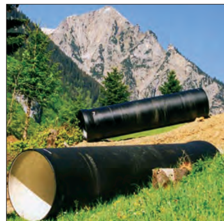
Bild 48: Gusseiserne Rohre der Größe DN 1200, die innen Keramik beschichtet und außen mit Korrosionsschutz versiegelt im Hochgebirge zum Einsatz kommen (Bild: ZGV, Düsseldorf)
