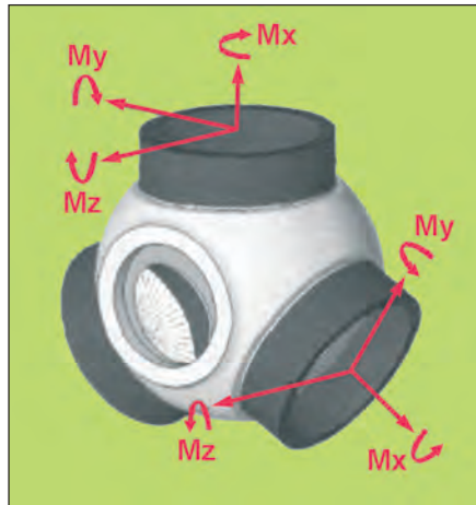
Bild 17: Auftretende Kräftelemente an einer Nabe für Windenergieanlagen
