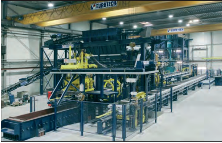
Bild 38: Moderne Formanlage für das Herstellen von Seriengussteilen in Sandformen
