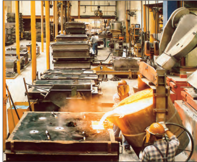
Bild 61: Abgießen einer Form, links im Bild der Induktionsfenschmelzbetrieb mit zwei Schmelzöfen (Bild: Eisen-gießerei H. Dhonau, Triberg)
