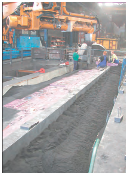
Bild 40: Herstellung einer Grubenform für ein sehr großes Gussteil (Bild: Meuselwitzguss)
