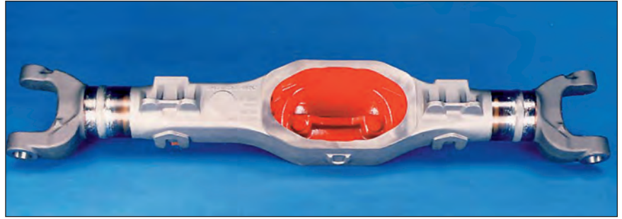
Bild 110: Vorderachskörper aus EN-GJS 400 -18 mit angeschweißten Gelenkstücken aus E295, Positioniergenauigkeit der Gelenkstücke kleiner \pm 1 Grad (Bild: W. Hundhausen, Schwerte)
