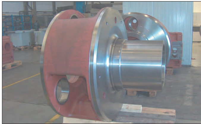
Bild 199: In der Gießerei bearbeiteter Planetenträger für Windenergieanlagen aus EN-GJS-700-2U, Gewicht 2,8 t (Bild: Flender Guss, Wittgensdorf)
