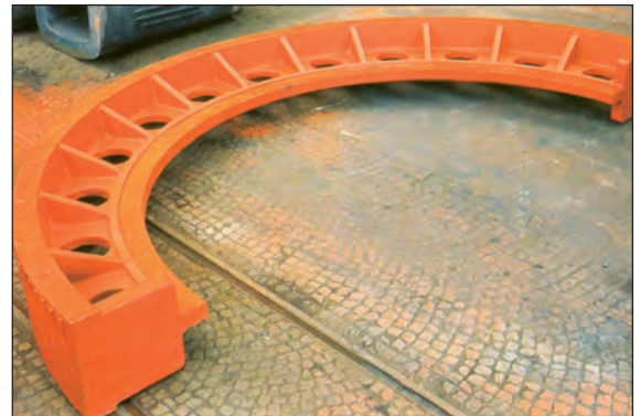
Bild 147: Zahnkranzhälfte aus EN-GJS-700-2, Gewicht 19,6 t, Abmessungen 7130 x 800, (Bild: ZGV, Düsseldorf)
