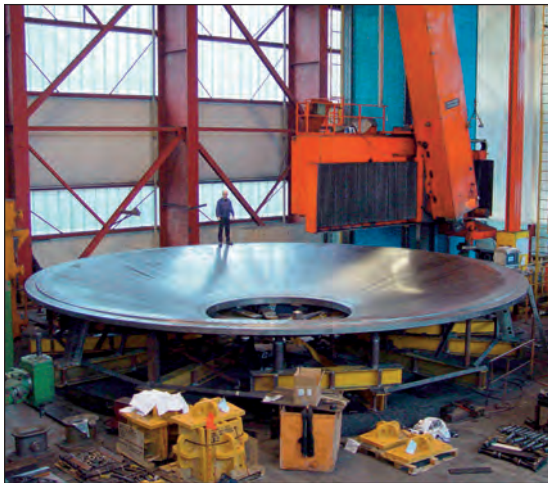
Bild 169: Bodenteil einer Erzmühle, bestehend aus vier Gussteilen aus EN-GJS-500-7, Gesamtgewicht etwa 200 t (Bild: Siempelkamp Krefeld)
