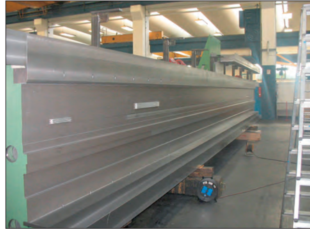
Bild 197: Bearbeitung eines gegossenen Querbalkens für eine Großwerkzeugmaschine aus EN-GJS-600-3, Gussgewicht 50 t (Bild: Meuselwitzguss)
