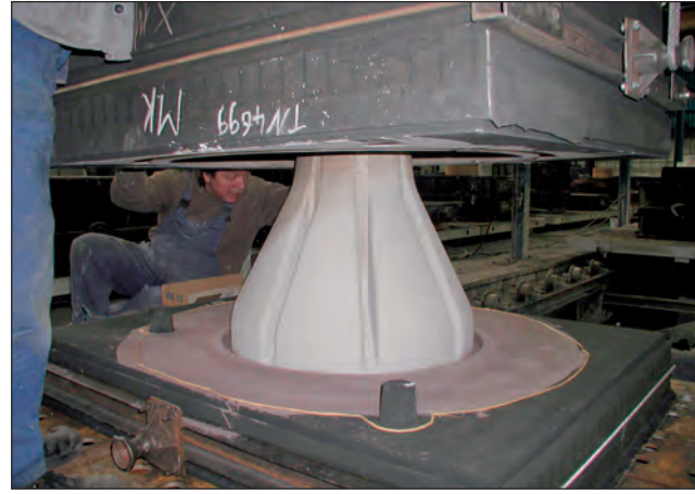
Bild 39: Eine mehrteilige kastengebundene Sandform beim Zulegen des nächsten Formkastenteiles, Kern (hell) (Bild: Meuselwitzguss)
