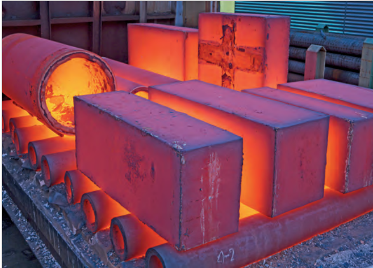
Bild 92: Auch Strang- und Schleudergussteile werden wärmebehandelt, aber auch die im Bild gezeigten Kokillengussteile (Blöcke und Büchsen) aus EN-GJS-600-3 (Bild: Gontermann-Peipers, Siegen)
