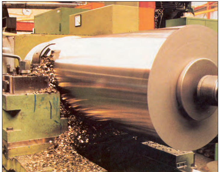
Bild 188: Im Kokillenguss hergestellter Rotor für einen Verdichter aus EN-GJS-400-15, Dmr. 400 mm, 1350 mm lang (Bild: Bosch-Rexroth, Lohr)
