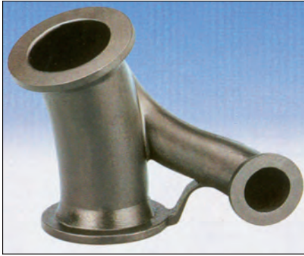
Bild 212: Abgaskrümmer für einen statischen Großdieselmotor aus GJS-SiMo5-1, Gewicht 82 kg, Abmessungen 850 x 555 x 380 mm (Bild: CLAAS GUSS, Bielefeld)
