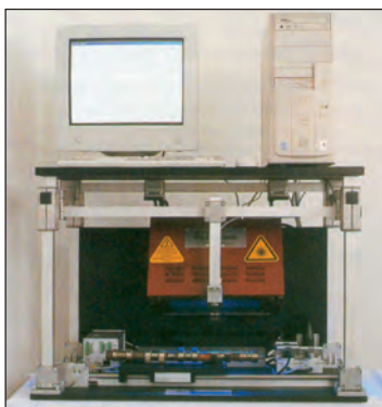
Bild 125: Anlage zur vollautomatischen Magnetpulver-Rissprüfung von Nockenwellen mit Hilfe optoelektrischer Systeme (Bild: K + D Flux-Technic, Mögglingen)
