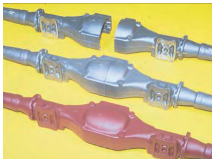
Bild 103: Abbrennstumpfgeschweißte Buchsachsenteile aus EN-GJS-600-3 (Bild: Georg Fischer Automotive, Schaffhausen)
