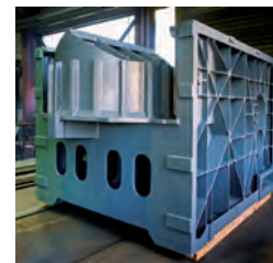
Fräsmaschinengehäuse aus EN-GJS-400-18
