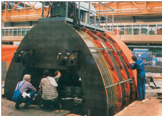
Bild 20: Wickelvorgespannte Konstruktionen sind auch bei Gussteilen aus GJS anwendbar, wie bei diesem Pressenkörper aus GJS-400-18, der für eine Haltekraft von 200 000 kN vorgespannt wurde (Bild: Siempelkamp, Krefeld)
