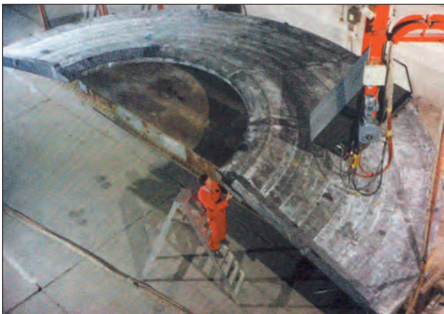
Bild 118: Durchstrahlungsprüfung eines Gussteils Mühlenboden aus EN-GJS-600-3 (Bild: ZGV, Düsseldorf)
