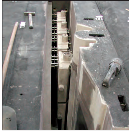
Bild 35: Herdform mit eingelegten Kernen, die wegen ihrer Größe und Masse mit Kernstützen abgesichert sind (Bild: Meuselwitz Guss)
