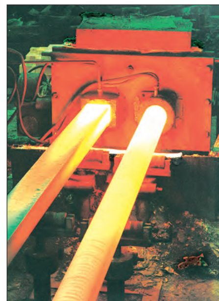
Bild 51: Stranggussanlage mit zwei kontinuierlichen Strängen für Viereck- (links) und Rundprofil (rechts) (Bild: Gontermann-Peipers, Siegen)
