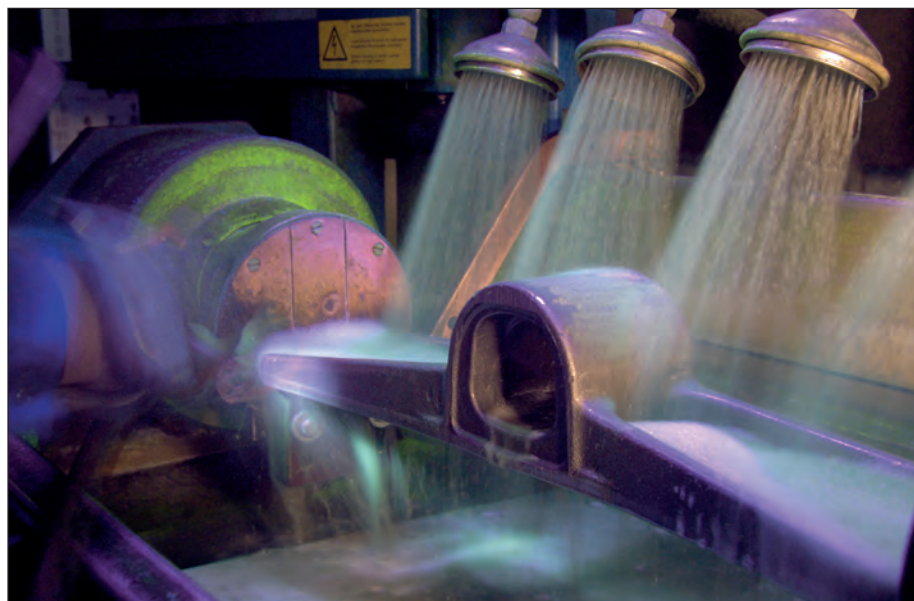
Bild 127: Sprühtestversuch zur Bestimmung der Korrosionsbeständigkeit von Gusseisen-teilen gegen Wasser und andere Medien (Bild: CLAAS GUSS, Bielefeld)
