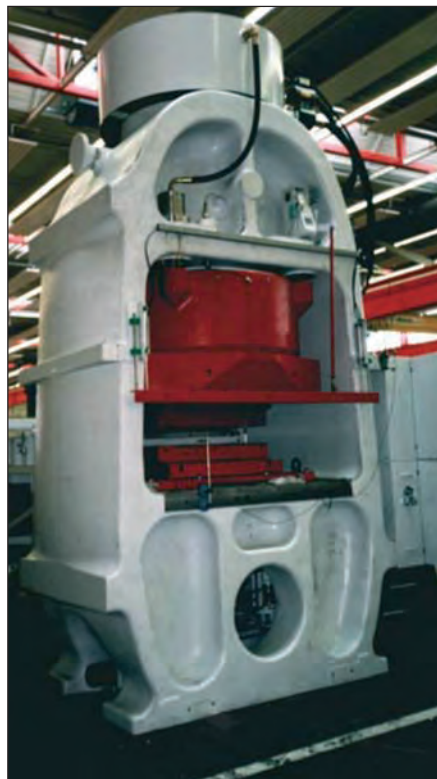
Bild 16: Eine Fliesenpresse mit Gussständer aus EN-GJS-400-15, Gewicht etwa 40 t (Bild: Siempelkamp, Krefeld)
