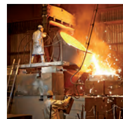
Eine Magnesiumbehandlung der Basisschmelze führt zur Ausbildung des kugelförmigen Graphits.
