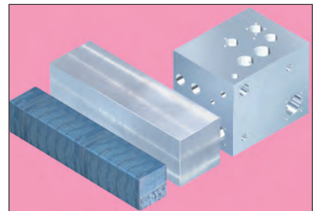
Bild 133: Strangguss kommt wegen seiner hohen Dichtigkeit bei Hydraulikgussteilen zum Einsatz (von links nach rechts: gegossene Stange im Rohzustand, vorbereitete und gebrochtes Bauteil) (Bild: Gontermann-Peipers, Siegen)
