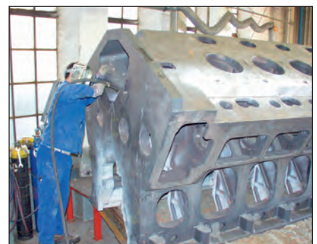
Bild 112: Artfremde Schweißung an einem 23 t schweren Motorblock aus EN-GJS-400-18U (Bild: Siempelkamp, Krefeld)
