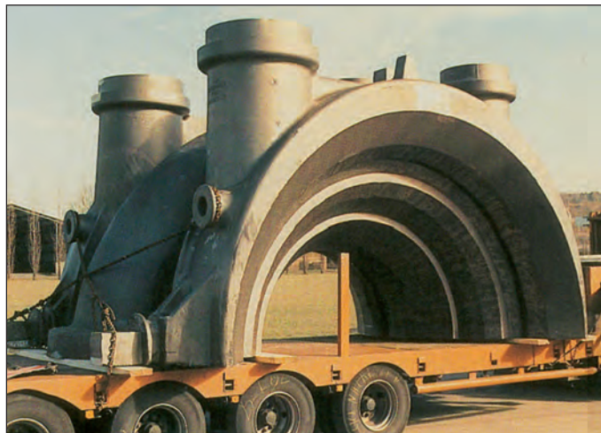
Bild 21: Dampfturbinen-Innengehäuse-Unterteil aus EN-GJS-400-15 für die Niederdruckstufe, Gewicht 43 t (Bild: ZGV, Düsseldorf)
