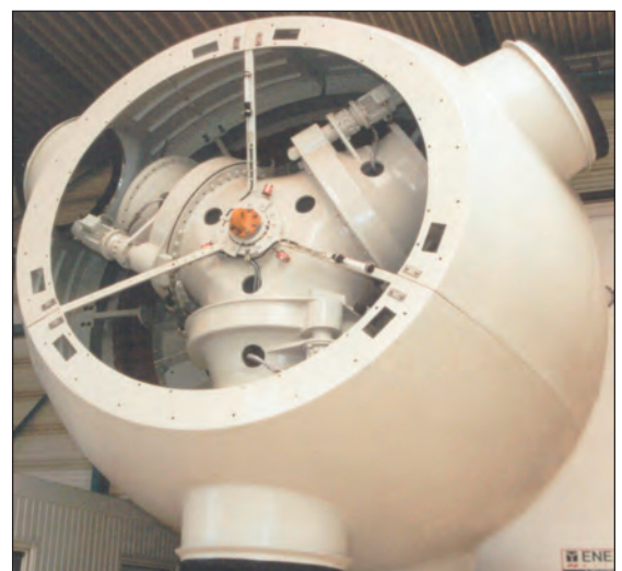
Bild 164: Im Gondelbereich von Windenergieanlagen sind neben dem Maschinenträger, Stratorstern, Achszapfen und Blattadapter sowie die Drehmomentstütze und der Planetenträger der Getriebe hoch belastbare Gussteile aus GJS. (Bild: ZGV, Düsseldorf)
