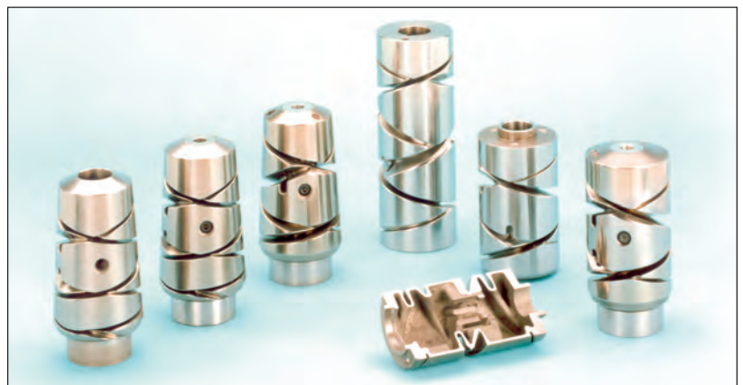
Bild 179: Fadenführungstrommeln für den Textilmaschinenbau aus EN-GJS-600-3 in verschiedenen Durchmessern von 96 bis 101 mm, Gewicht 4,5 bis 9 kg (Bild: CLAAS GUSS, Bielefeld)
