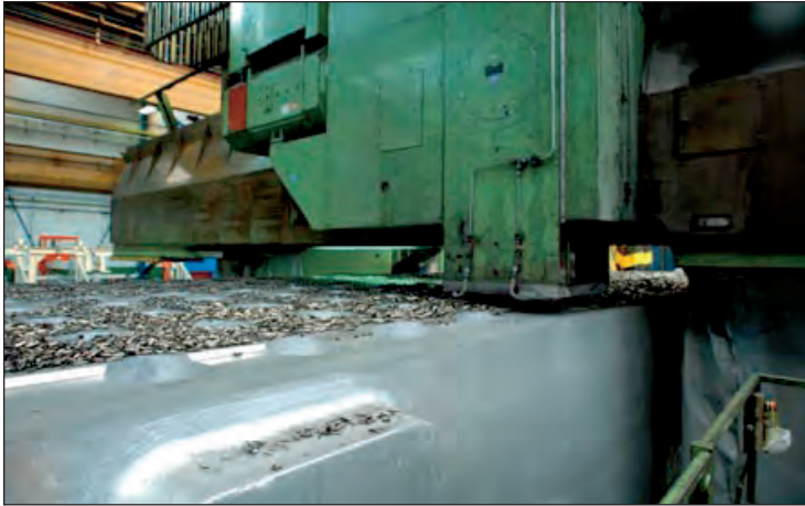
Bild 196: Fräsbearbeitung der bisher größten gegossenen Mehretagenpresse mit Plattenteilen 3 785 x 10 515 mm mit je 215 t Rohgussgewicht aus GJS (Bild: Siempelkamp, Krefeld)
