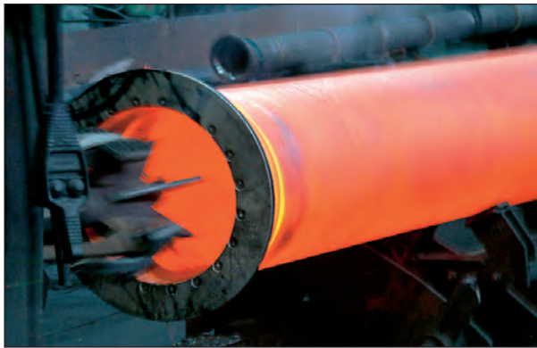
Bild 3: Schleudergussrohr im noch glühenden Zustand bei Herausziehen aus der Schleudergießmaschine (Bild: FACHGEMEINSCHAFT GUSS-ROHRSYSTEME, Berlin)
