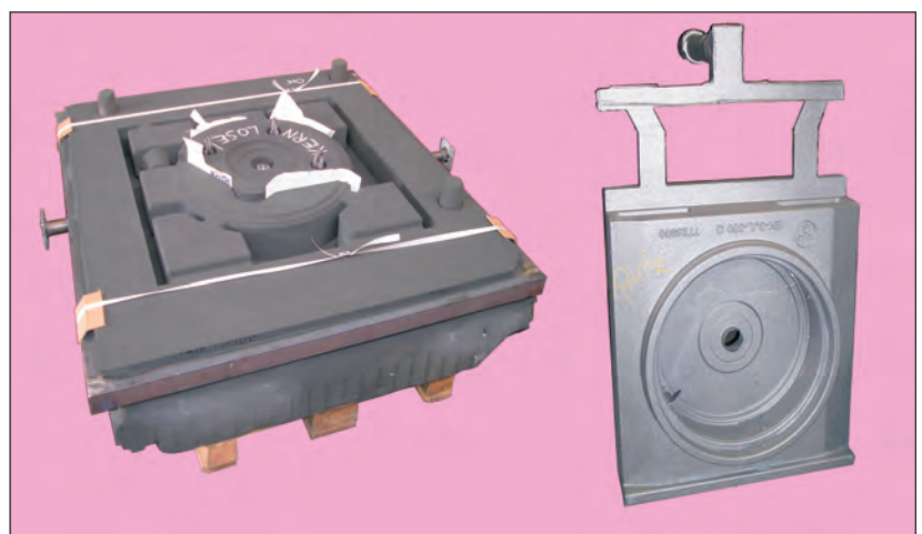
Bild 30: Aus Formstoffblöcken gefrästes Formsegment mit Kern (links) und daraus in Rekordzeit ohne Modelleinrichtung gefertigter Prototyp eines Schwenktischgehäuses (rechts) (Bild: Heidenreich & Harbeck, Mölln)
