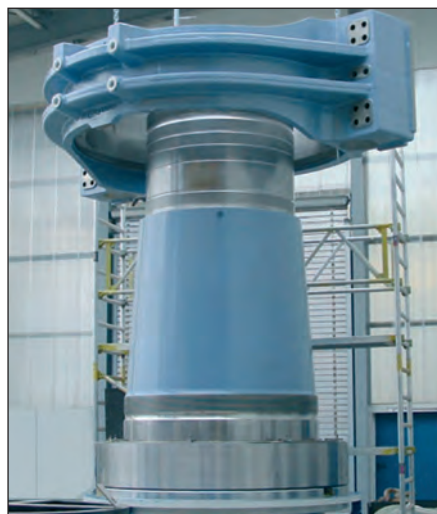
Bild 27: Rotorhohlwelle für 5MW-Windenergieanlage im Offshore-Einsatz aus der kaltzähnen Legierung EN-GJS-400-18-LT für den Einsatz bei tiefen Temperaturen, Gewicht 37 t (Bild: Walzengießerei Coswig)
