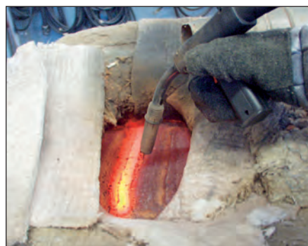
Bild 111: Detailansicht des präparierten Schweißbereiches für das Metalllichtbogenschweißen mit Fülldrahtelektrode von großen Gusseisenteilen (Bild: Siempelkamp, Krefeld)
