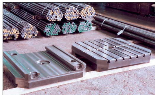
Bild 217: Zwei bearbeitete Palettentische aus EN-GJS-500-7 der Abmessungen 1040 x 1040 mm und Stranggussabschnitte im Hintergrund (Bild: Gontermann-Peipers, Siegen)
