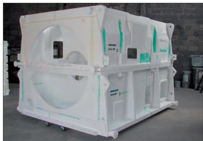
Bild 42: Mehrteiliges Schaumstoffmodell für ein Planetengetriebegehäuse-Gussteil eines Schiffsantriebes, bestehend aus Ober- und Unterteil (links) und das im Vollformverfahren abgegossene Gussteil (rechts), Abmessungen 3,5 x 2,7 x 2,45 m, Gesamtgewicht 18 t (Bild: Römheld & Moelle, Mainz)
