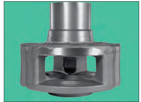
Bild 142: Planetensteg für Windenergieanlagen und andere Großgetriebe aus EN-GJS-700-2 und ADI-Gusseisen als Ersatz für Stahlguss (Bild: Silbitz Guss)
