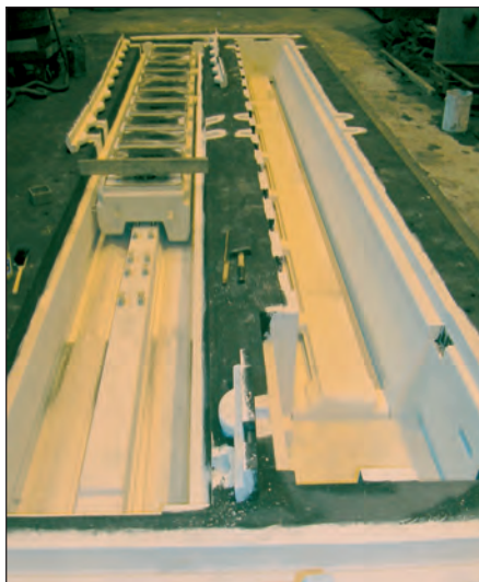
Bild 41: Grubenform mit hinten links bereits eingelegten Innenkernen für ein Gussteil Querbalken für Portalfräsmaschine aus EN-GJS-600-3 (Bild: Gontermann-Peipers, Siegen)
