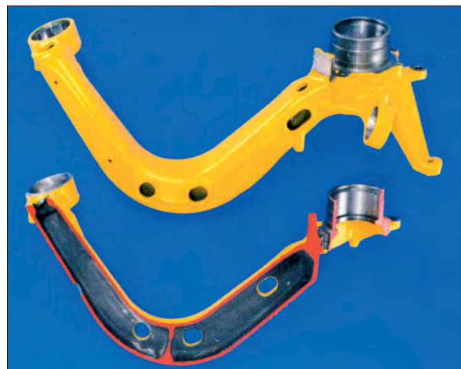
Bild 156: Längslenker für PKW aus GJS in belastungsoptimierter und massereduzierter Ausführung durch Nutzung konstruktiver Hohlstrukturen (Bild: Georg Fischer Automotive, Schaffhausen)
