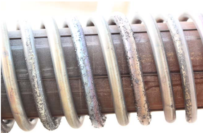
Abb. 130: Post-Mortem Aufnahmen der Rohrwendel zur Überhitzung des Wasserdampfs im inneren des gewickelten Rohres
