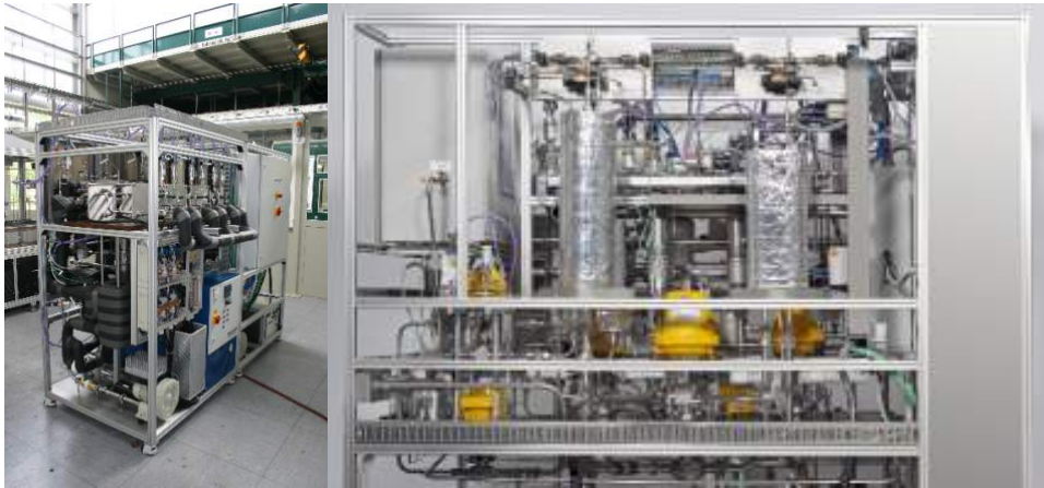
Abb. 157: Stackmodul für die Aufnahme von Stacks der Fa. Sartorius Stedim Biotech (links) und Brenngaserzeugungsmodul (rechts) mit den Kernkomponenten ATR 8.1 und WGS 3.
