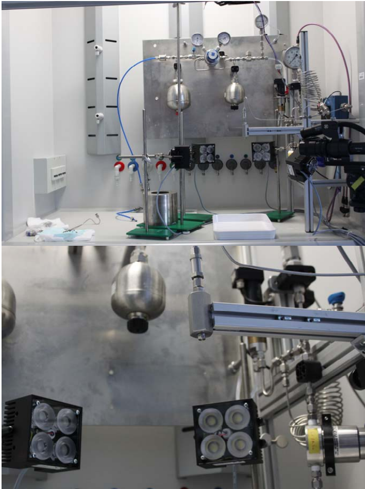
Abb. 61: Düsenprüfstand – in der Detailansicht mit LED-Beleuchtung und zu testender Dralldruck-Düse.
