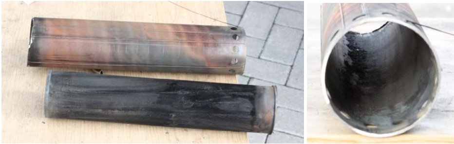
Abb. 129: Post-Mortem Aufnahmen der inneren Einbaurohre zur Abtrennung der Wärmeaustauscherkammern
