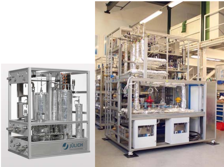
Abb. 167: Package 1 mit den Komponenten Reformer ATR 9.1, Shiftreaktor WGS 3 und Katalytbrenner CAB 2.2 in der 5 kW e Klasse (links) und Modul B (rechtes Foto) zum Test von Brennstoffzellen-Packages.
