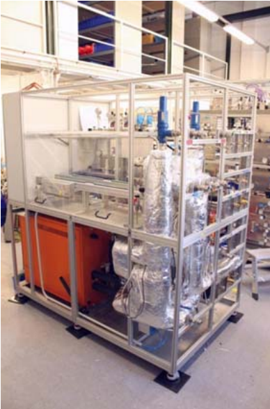
Abb. 165: Versuchsaufbau (Modul E, Abbildung links) zum Test von IEK-eigenen HT-Stacks (Abbildung rechts)
