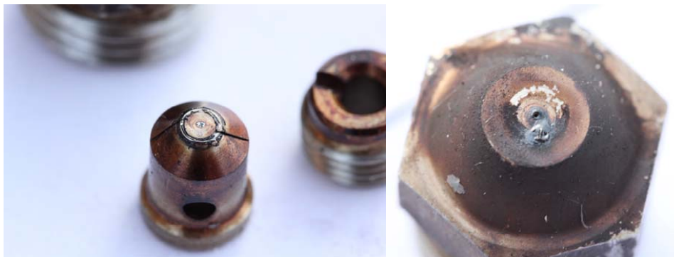
Abb. 120: Post-Mortem Aufnahmen der ausgebauten Dralldruckdüse des ATR AH1.
