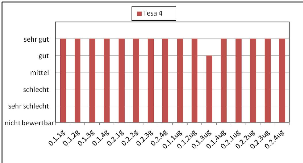
Abbildung 124: Ergebnisse Haftungstest, Tesa, Offsetdruck
