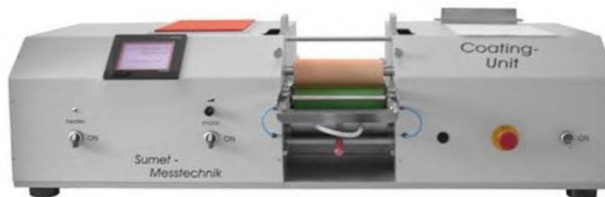
Abbildung 40: Laborcoater der Fa. Sumet (Quelle: Sumet)
