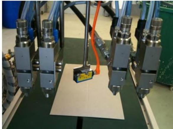
Abbildung 33: Düsen und Initiator der Kallleimsprühanlage
