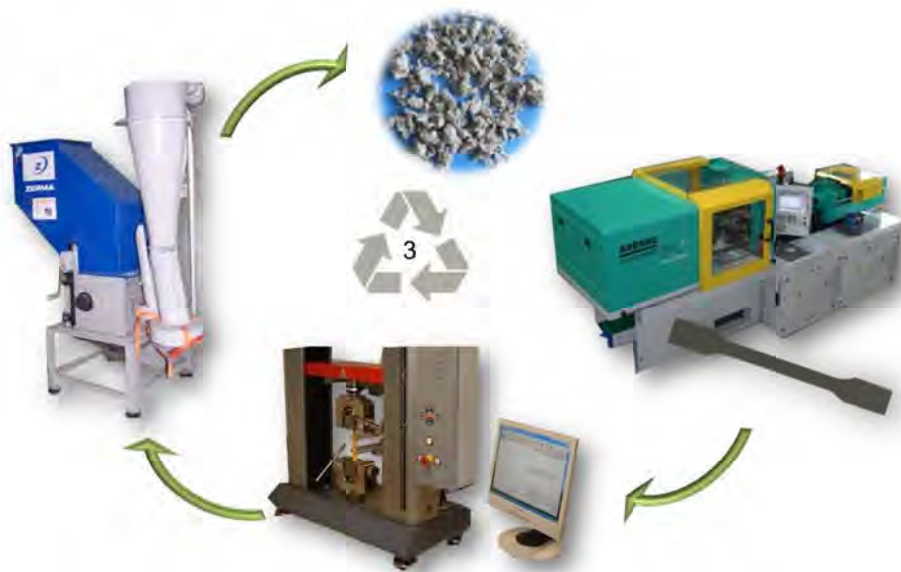
Abb. 18: Ablauf des Recyclingversuches PPC-Werkstoffe
