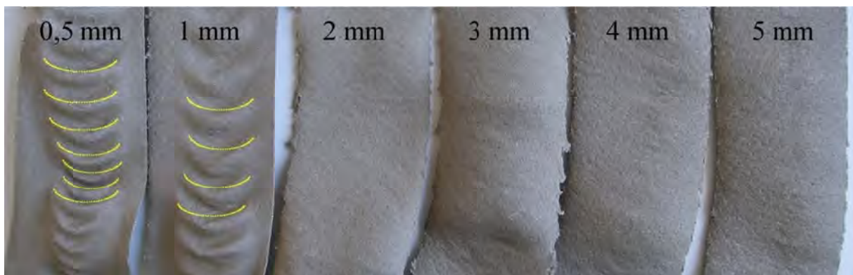
Abb. 23: Fließverhalten der PPC-Schmelze in Abhängigkeit vom Düsenpalt
