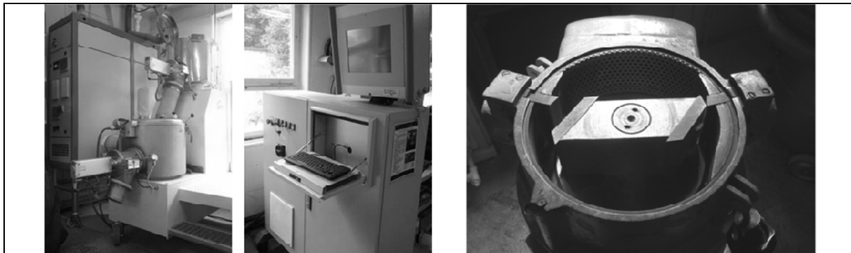
Abb. 13: Heiz-Kühl-Mischer M 35 Fk/KMV 60 links und Granulierer rechts
