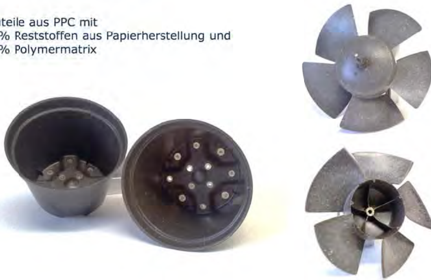
Abb. 24: Muster von Spritzgussteilen aus der Projektarbeit
