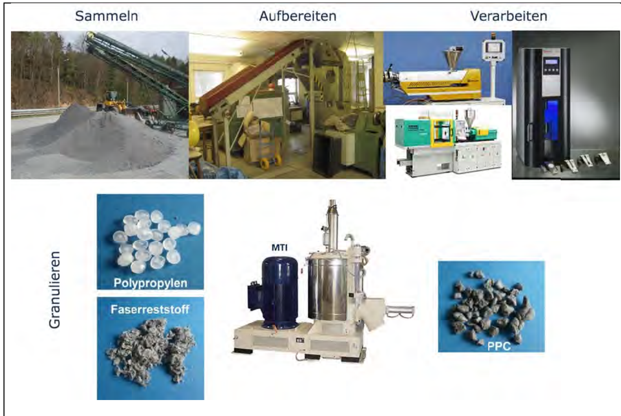
Abb. 12: Arbeitsabläufe PPC-Herstellung (Labor)
