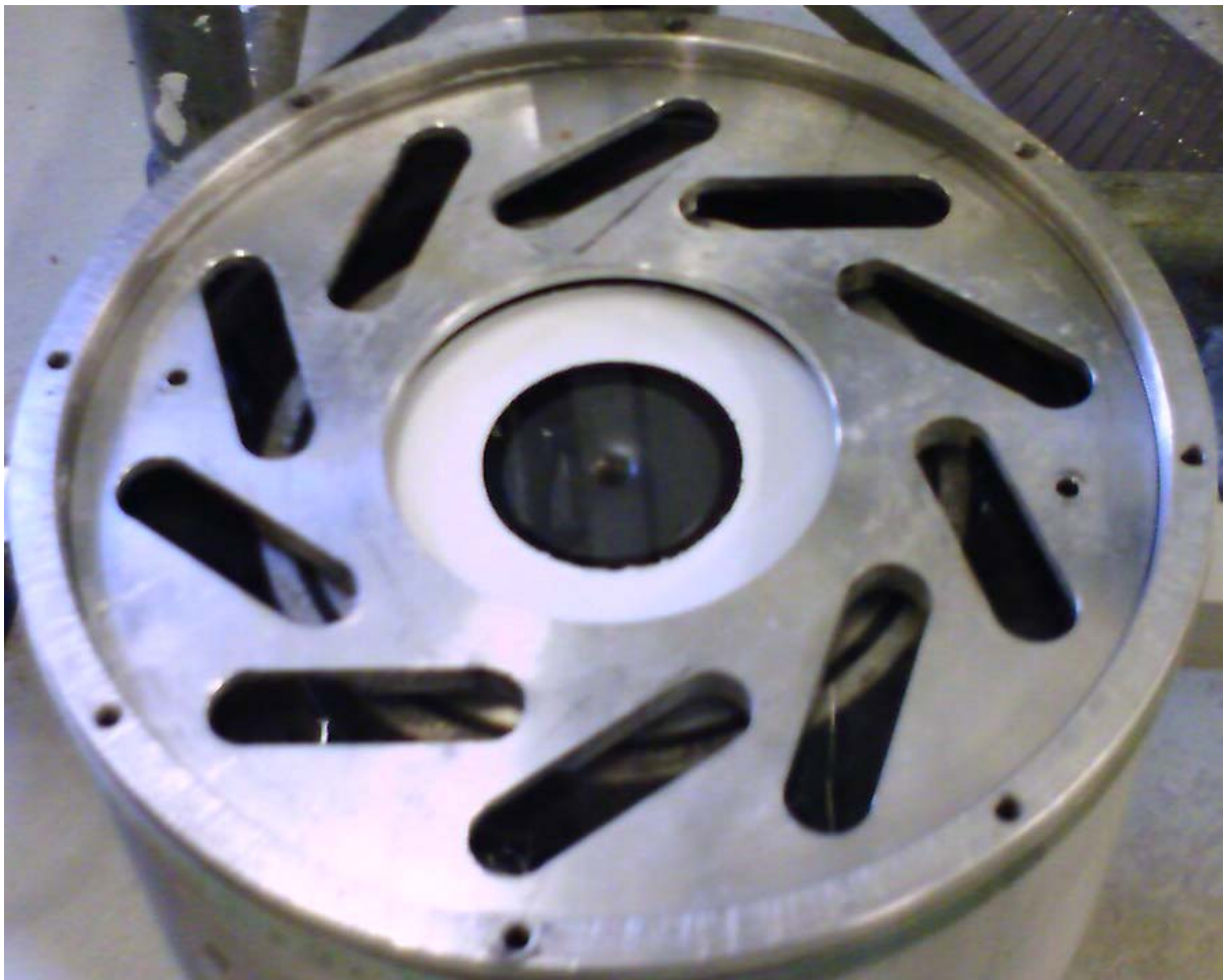
Abb. 30: Einspannung des Messfenster mit Aussparungen für Halogenlampen
