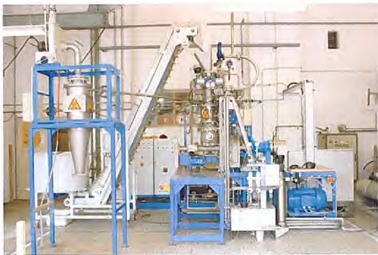
Abbildung 4.11: TMP-Anlage am IHD (Quelle: IHD) – quasi kontinuierlicher Betrieb
