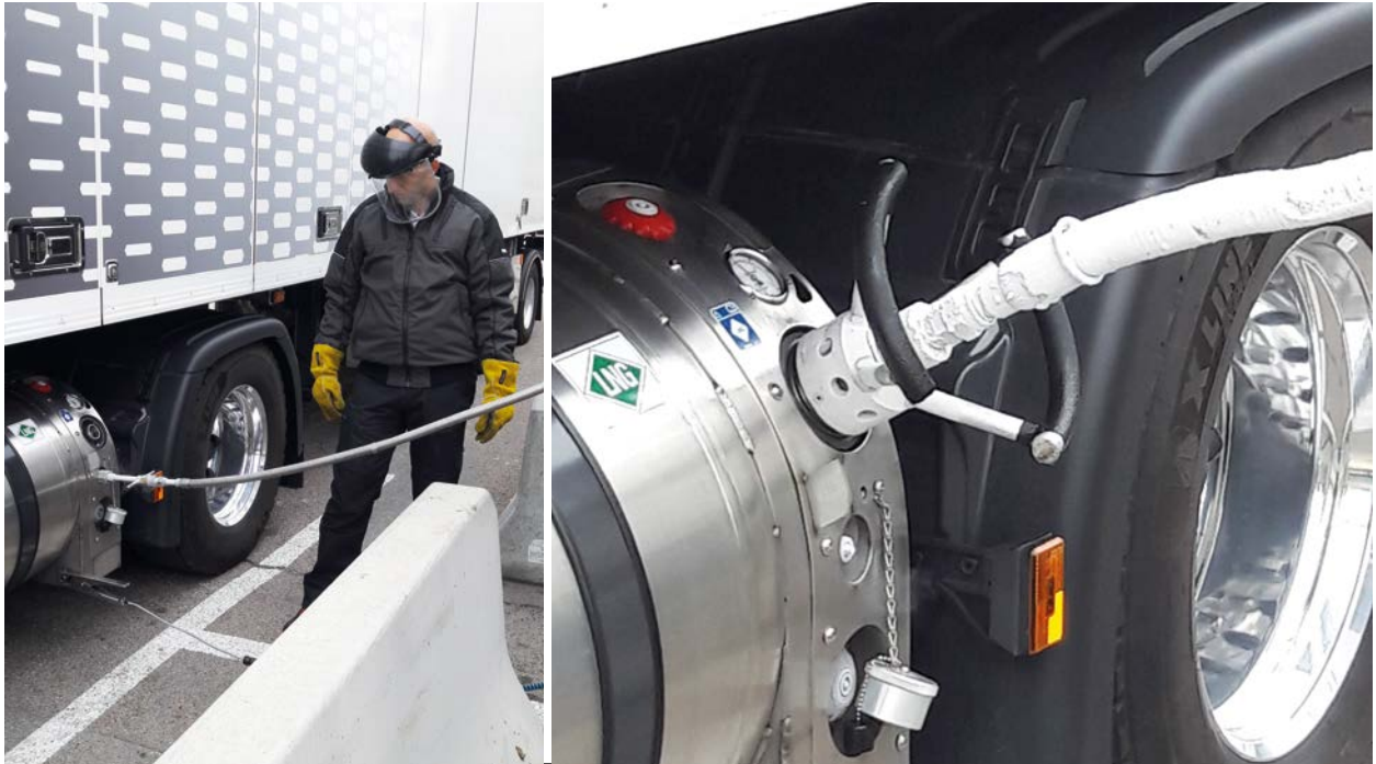
Abbildung 8: LNG-Betankungsprozess – Erdung, Gasrückführung (links); LNG-Füllkupplung (rechts)
