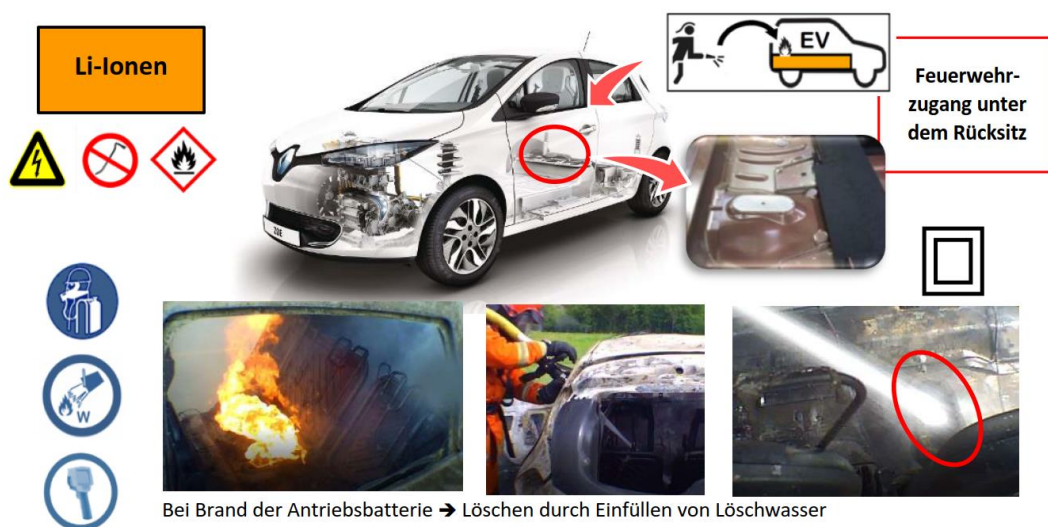
Abbildung 26 Rettungsdatenblatt Renault Zoe 50 mit Angabe des spezifischen Feuerwehrezugangs und der Empfehlung von Wasser als Bekämpfungsmittel ([69])
