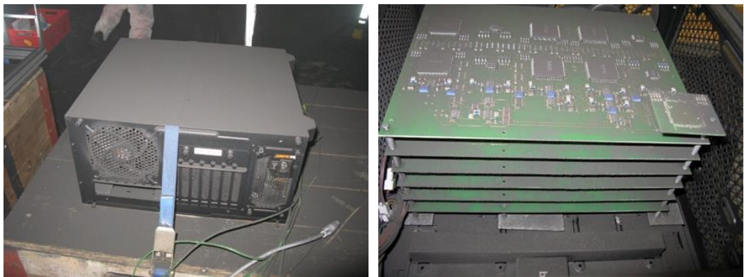
Abbildung 17 PC Gehäuse (links) und Leiterplatten (rechts) nach Brandversuch
