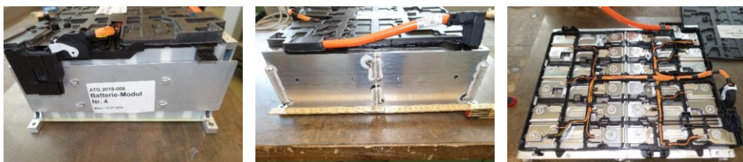
Abbildung 24 Aufbau Batteriemodul mit untersuchten Bauteilen aus Kunststoff und Metall
