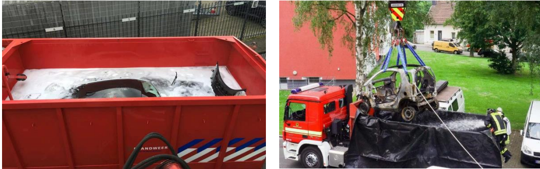
Abbildung 27 Aktuelle Praxislösungen zur Kühlung von havarierten BEV-Wracks (Quellen siehe Fussnoten 4 und 5 )
