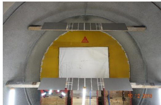
Abbildung 14 Anordnung der Schutzausrüstung (links) sowie der Kollektorbleche (rechts)
