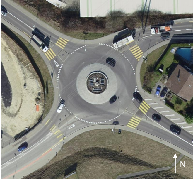
Abb. 175 Knoten mit Kreisverkehr («Standardkreisel»), Knoten Route de Belfaux / Route Jo Seiffert / Route des Taconnets in Givisiez (Swisstopo, 2020)
