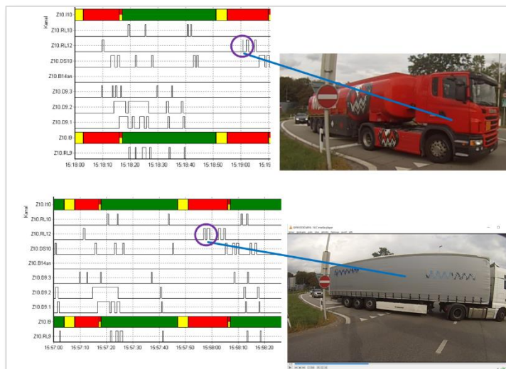
Abb. 215 RL13 in der Zufahrt von Norden detektiert Zugfahrzeuge
