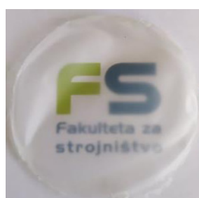
Fig. 2. Composite chitosan CNF membrane
