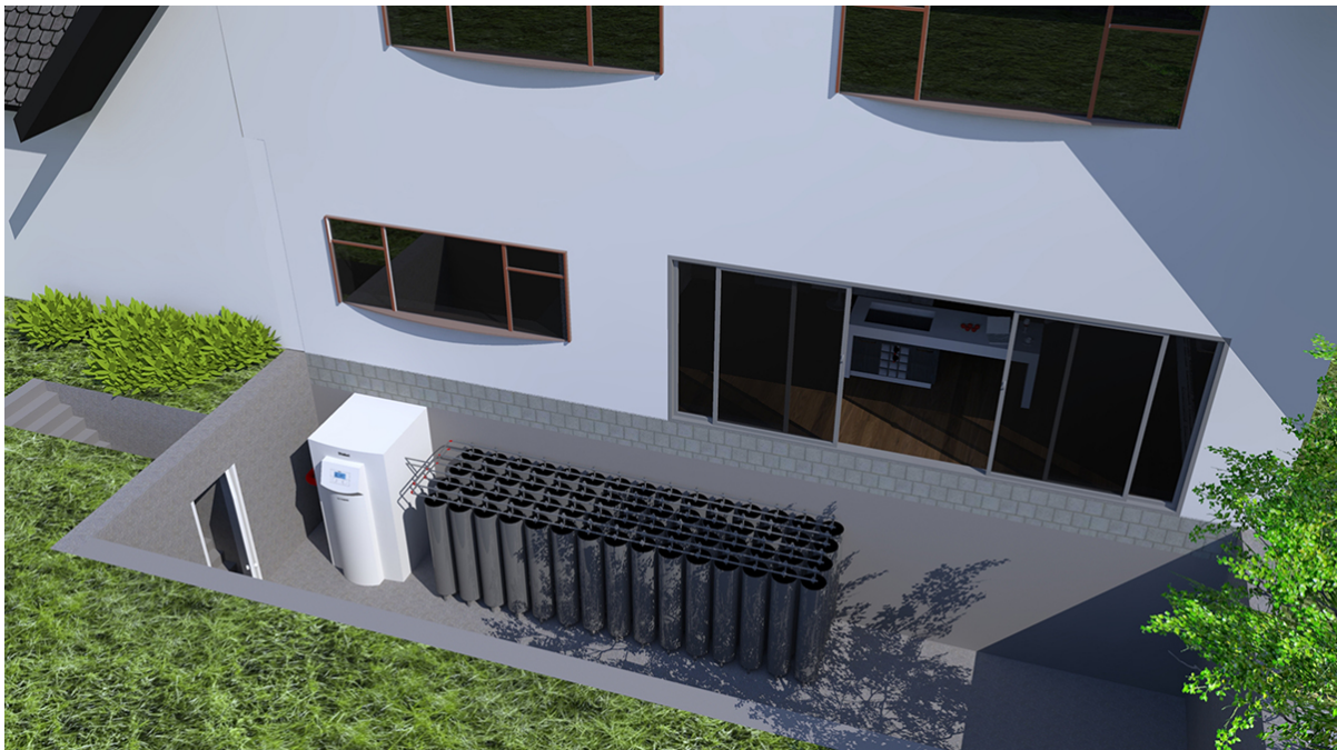
Abb. 4: Clusterlatentwärmespeicher in die Terrasse eines Wohnhauses integriert
