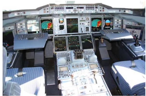
Abb. 2b: Cockpit mit Sidestickanordnung
